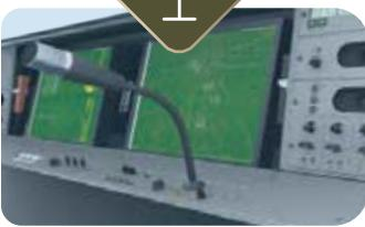
Аппаратура объективного контроля обеспечивает синхронную запись в режиме реального времени и воспроизведение на любом рабочем месте группы руководства полетами (РМ ГРП) радиолокационной, речевой, телевизионной и любой другой текущей информации. Регистрация осуществляется автоматически на всех модулях обработки и отображения РМ ГРП.
